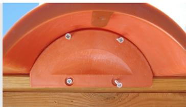
1. Tampa antipássaros, são colocados 2 parafusos no ressalto da telha e 2 parafusos na ripa. Esta peça fixa à obra A PRIMEIRA LINHA de telhas evitando, assim, colocar parafusos visíveis no telhado. 4 peças/ml.
